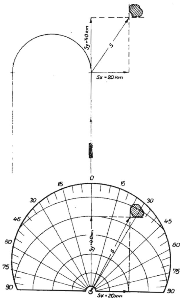
Abb. 17 Lage der Anzeige auf dem Schirm des Sichtgerätes, die den Beginn der I. Kurve bestimmt
