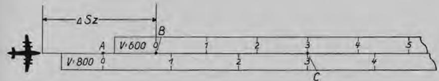
Abb. 18 Lösung von Abfangaufgaben mit Hilfe von Geschwindigkeits-Zeitlinealen beim Einholen auf gleichem parallelen Kursen
