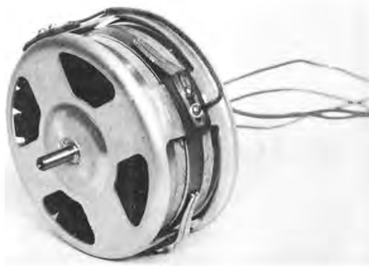
Abb. 45 Außenansicht des Sinus-Cosinus-Potentiometers (SKP)
