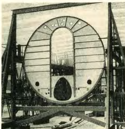
△ Bild 1.35 Rumpfzusammenbau Unterschale mit Fußbodenträgern und ein Hauptspant sichtbar
