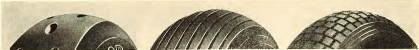
**Bild 1.42** Flugzeugreifen-Profilformen
